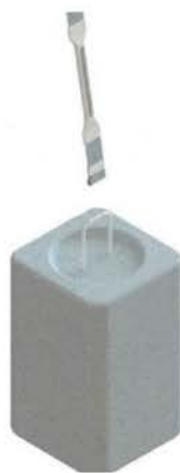
Figura 06 - Cintas de ancoragem
